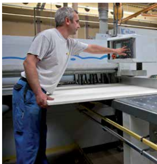
Au millimètre près : poste de découpe sur mesure des panneaux de support.
