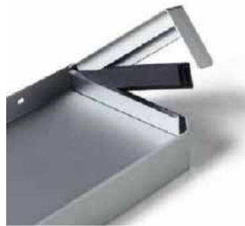
Esthétique et fiable: le seuil de fenêtre Sto-Fensterbank Profi. Le talon de seuil possède un profil de dilatation qui reprend les tensions de dilatation.
