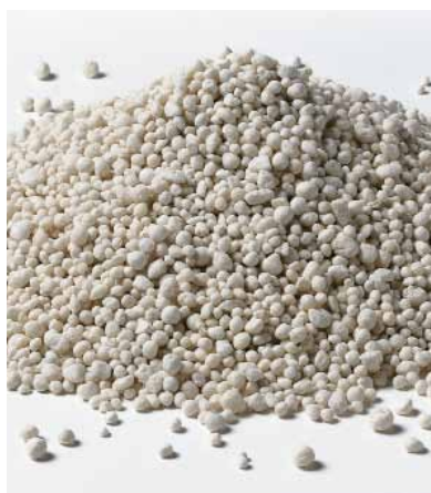
Les particules de verre sont au moyen de liant formé pour créer le StoReno Plan.
